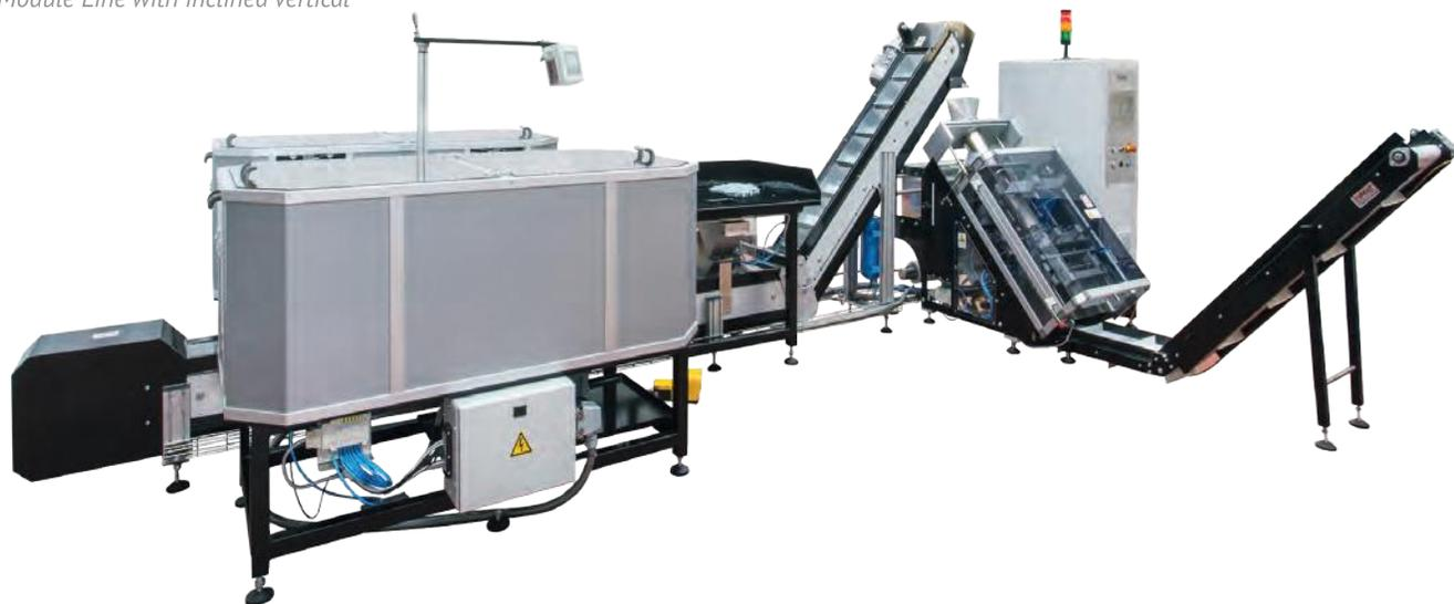
Linea di confezionamento con n°4 stazioni di carico automatico studiate per ogni prodotto. Normalmente abbinata a controllo peso di fine linea. Adatta a confezionare prodotti pesanti e delicati come raccordi, valvole o ferramenta con pesi importanti grazie alla caduta dei pezzi a 45°.
